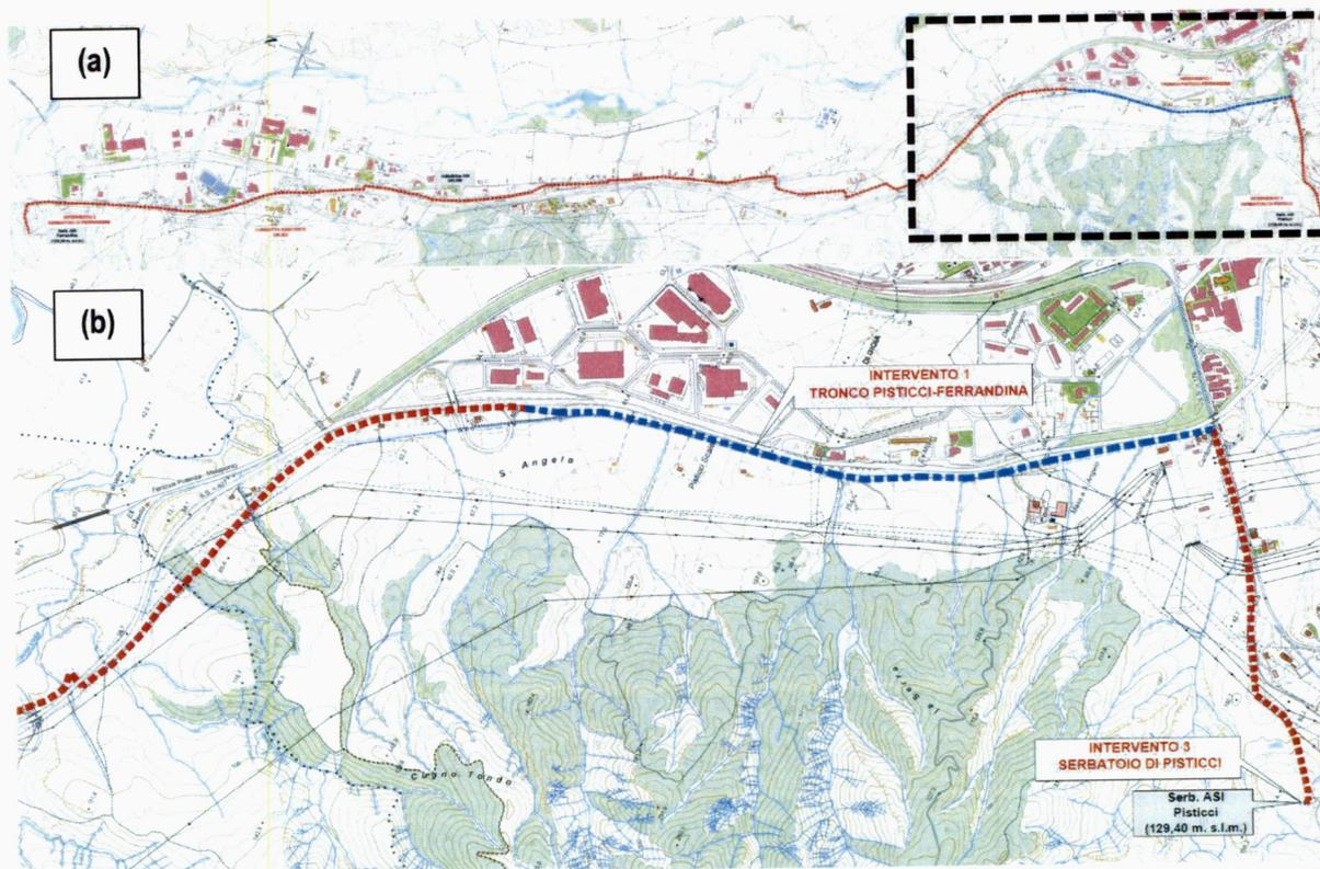
**Fig. 1** – Tracciato della condotta Pisticci – Ferrandina (a) con indicazione del tratto di intervento (b)
